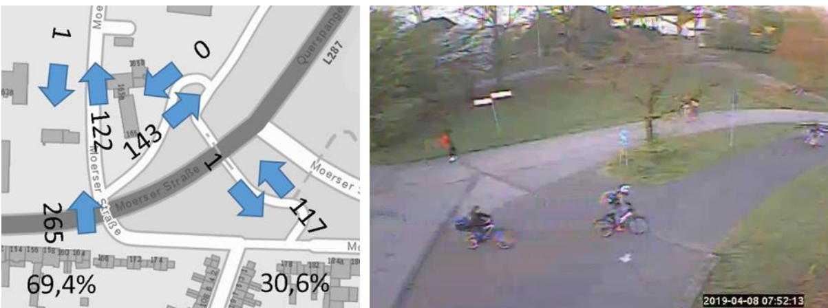
Abbildung 42 Verteilung des Radverkehrs auf die verschiedenen Routen (7:30-8:30 Uhr). Die objektiv sichere Route durch die Unterführung (rechts) wird nur in 30% der Fahrten genutzt
