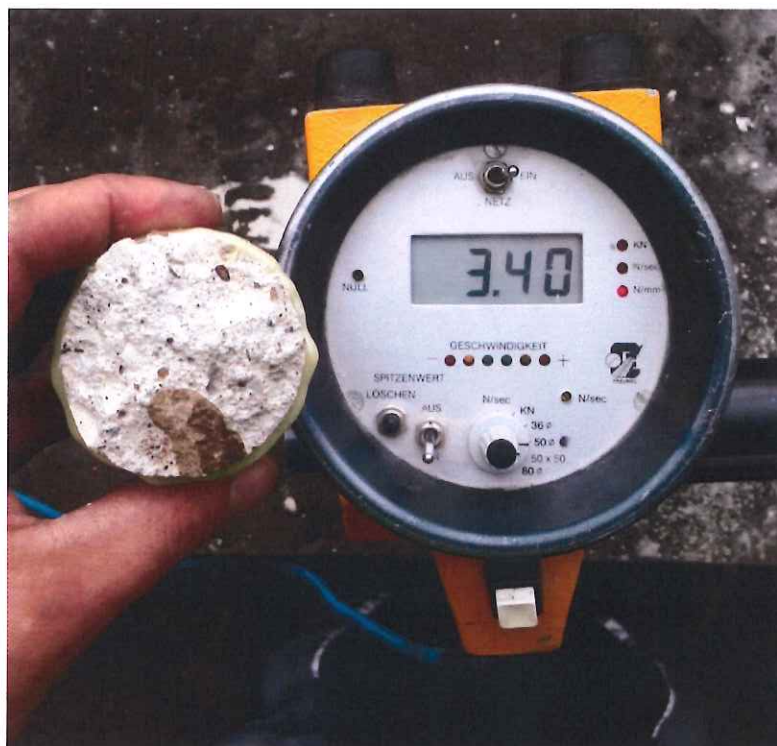
Abbildung 41: Exemplarische Ansicht des Prüfergebnisses OZ 1 mit 3,40 N/mm 2
