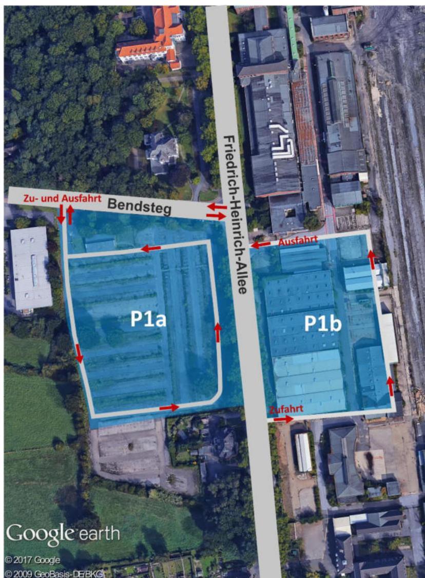
Zur Organisation der Verkehrslenkung auf die Parkplätze wird empfohlen, eine separate Zufahrt für aus Richtung Süden kommenden Anreiserverkehr auf den Parkplatz P1b einzurichten. Der Abreiseverkehr kann hingegen vollständig über den erweiterten Knoten Bendsteg / Friedrich-Heinrich-Allee abgewickelt werden. Ebenso wird empfohlen, den An- und Abreise-Verkehr auf den Parkplatz P1a vollständig über den erweiterten Knoten abzuwickeln. Damit wird im Kontext der Maßnahme
