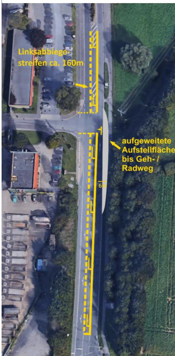
Der Knotenpunkt B528 / Friedrich-Heinrich-Allee stößt im Planfall 2020 an die Grenze der Leistungsfähigkeit, so dass ohne weitere Optimierungen die Leistungsfähigkeit nicht gegeben ist. Durch Optimierung des Festzeitenprogramm können die mittleren Wartezeiten an diesem Knoten so reduziert werden, dass die Leistungsfähigkeitsstufe D erreicht wird.
